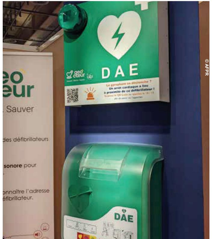
Géocoeur est un panneau connecté en permanence aux services de secours. Il est installé au-dessus d'un défibrillateur.
